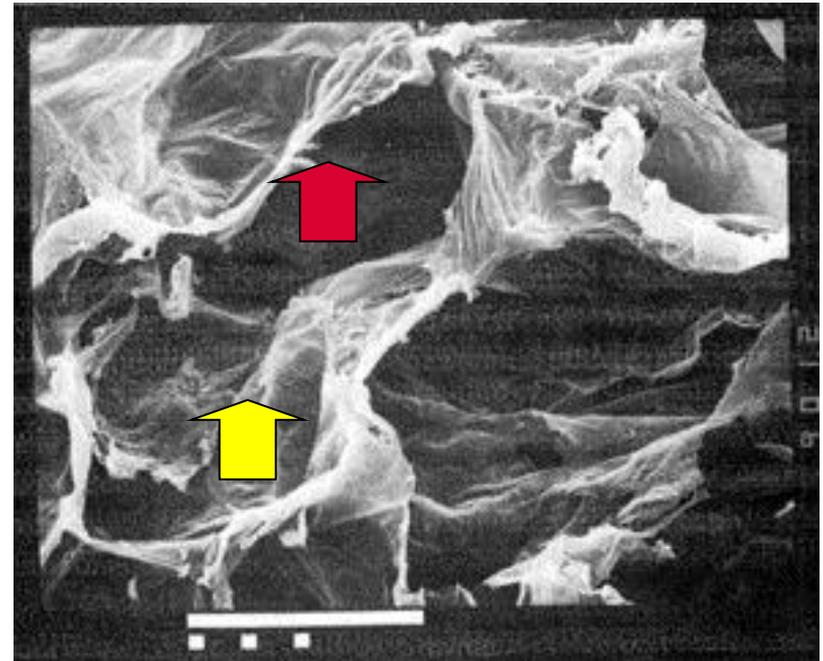
Detalle de células colapsadas, Paredes más delgadas sin Ca
